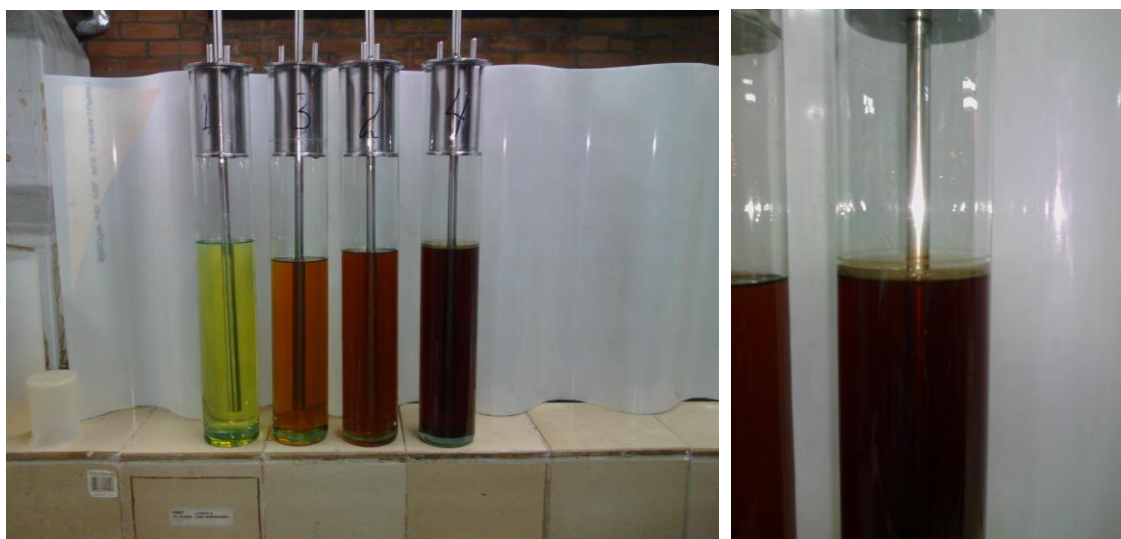
Fig. 6. Imagen de la Mezclas después de la prueba. Obsérvese el anillo de Goma adherente en la parte superior de la Mezcla No. 4
