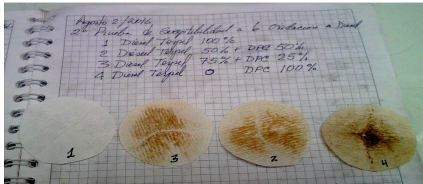
Fig. 11. Formación de Goma Insoluble en Thinner a partir de mezclas de Diesel Terpel con Diesel DPC.
